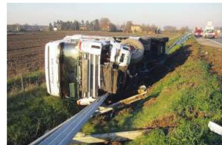
2A e 2B. Una barriera installata in situ (2A) e il suo comportamento in seguito a un impatto da parte di un veicolo (2B)
