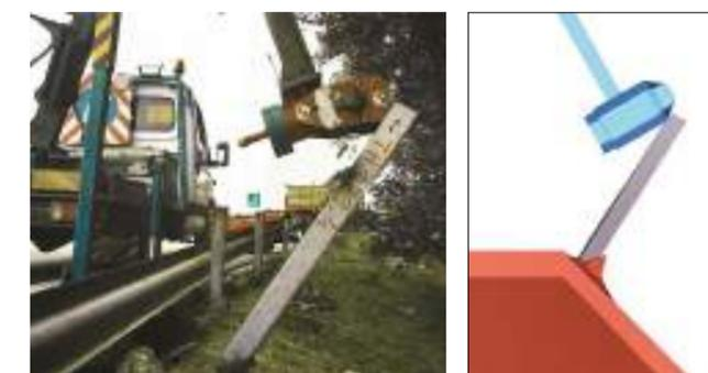
7A e 7B. La calibrazione del terreno in situ mediante prove dinamiche e simulazioni
