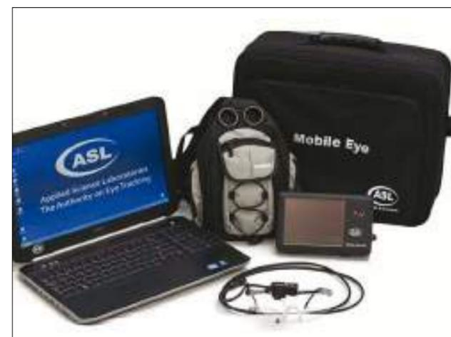
4. I componenti dello strumento Mobile Eye Tracker
