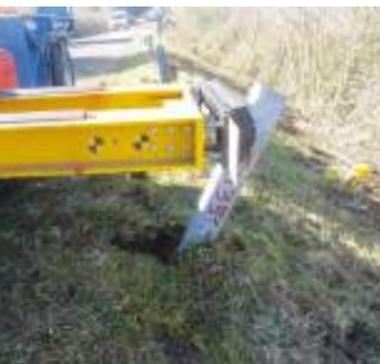
5A e 5B. La configurazione post-urto dinamico di un palo installato in sito (5A) e in campo prove (5B)
