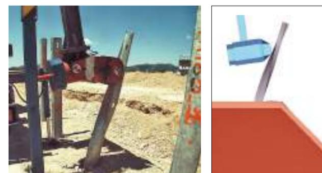
6A e 6B. La calibrazione del terreno del campo prove mediante prove dinamiche e simulazioni
